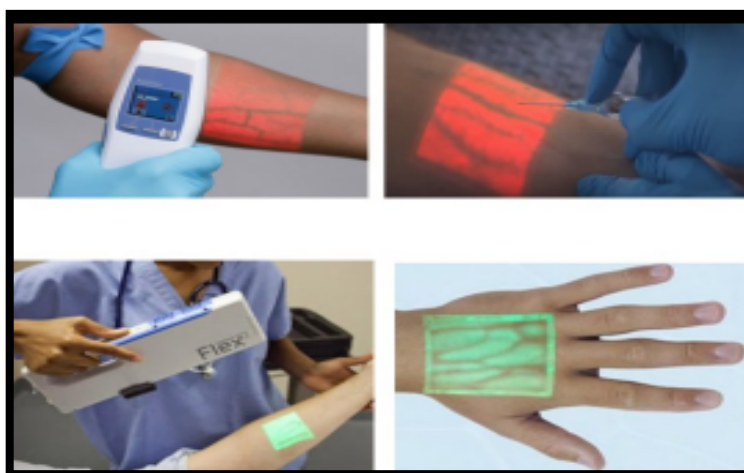
Figura 8: Dispositivo AccuVein® (arriba) y Vein Viewer Flex® (abajo).
